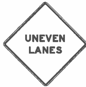
UNEVEN LANES SIGN
